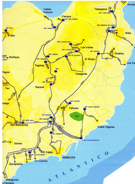
Figura 44. Redes primarias y secundarias de distribución
